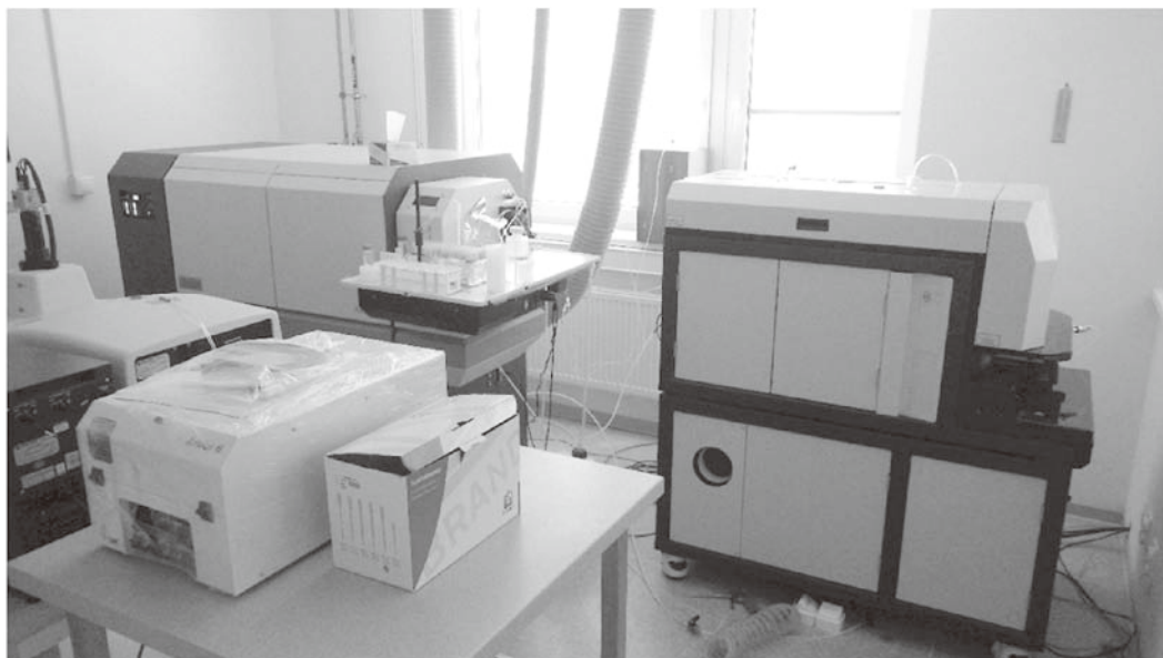
図4 レーザーアブレーション融合イオンプラズマ質量分析計（LA-ICP-MS分析機器）Thermo Scientific社製「ELEMENT 2」。左奥がICP-MS本体，右側がレーザー。
